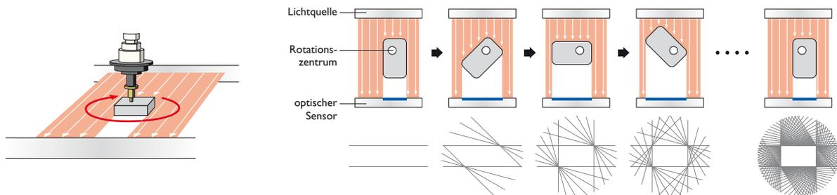
Das sogenannte Tangential Line Centering™ erlaubt sowohl ein grösseres Bauteilspektrum als auch eine höhere Genauigkeit. Der LNC60 vermisst Mittelpunkt, Abmessungen und Winkelkorrektur der Bauteile in einem einzigen Durchgang. Das Layout wurde vereinfacht und ermöglicht eine grössere Zuverlässigkeit bei flacherem und leichterem Gehäuse.
