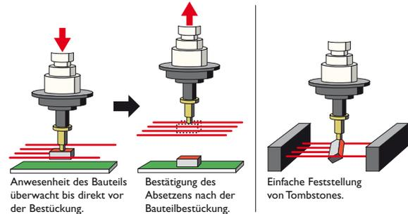
**LNC60** Mit diesem Konzept in der Bauteilzentrierung werden vier Bauteile gleichzeitig zeitneutral zentriert.
